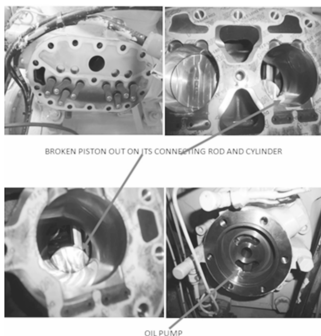
图 2 82 000 DWT 散货船制冷压缩机损坏情况
