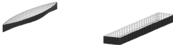
图 4 HydroSTAR 两船旁靠示意图
