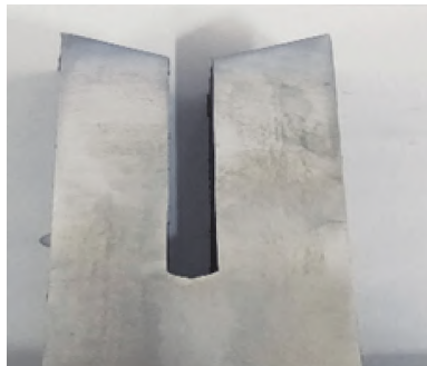
图 10 窄间隙焊接试件焊道断面图
