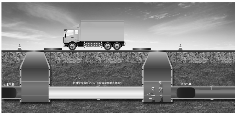
图 5 固化后切除多余尾料示意图
